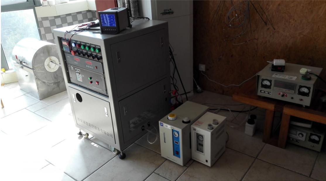
图 7，加热器与容器和真空系统、氢气发生器连接就位
