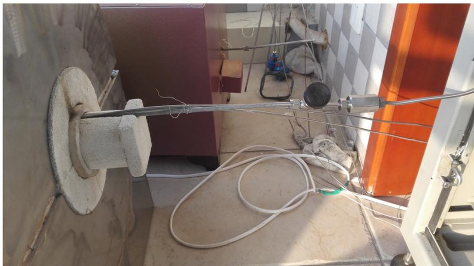
图 6，容器安装于加热管内，测压管与真空设备连接，热电偶引出
