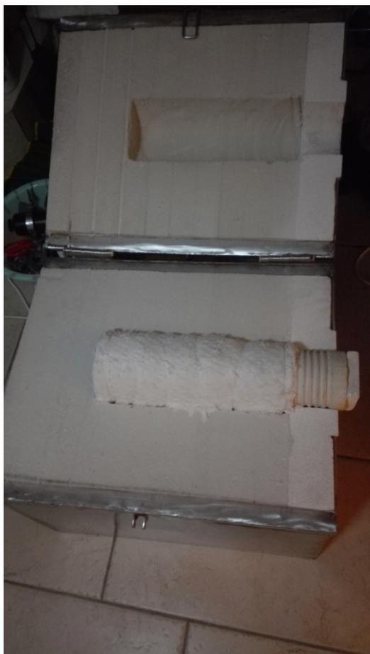
图 4，加热器安装在保温壳内
