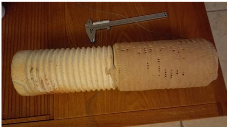
图 3，缠绕电阻丝的加热器
