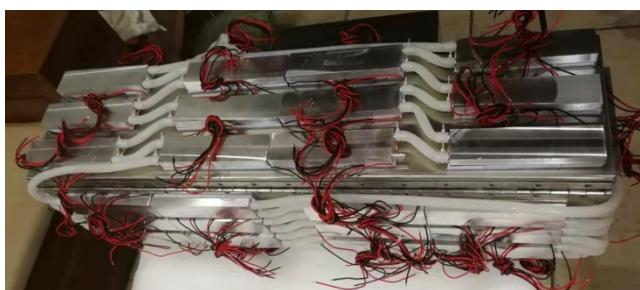
塞贝克元件连接电线
