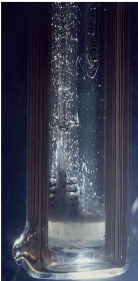
图 5. 在比伯里安（Biberian）和朗查姆普特（Lonchampt）的实验中正在电解的 ICARUS 电解池近照。J.-P.比伯里安供图。
