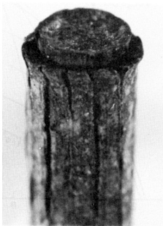
图 8 熔盐的高温电解充氢实验中用过的阴极钽棒 [129]
