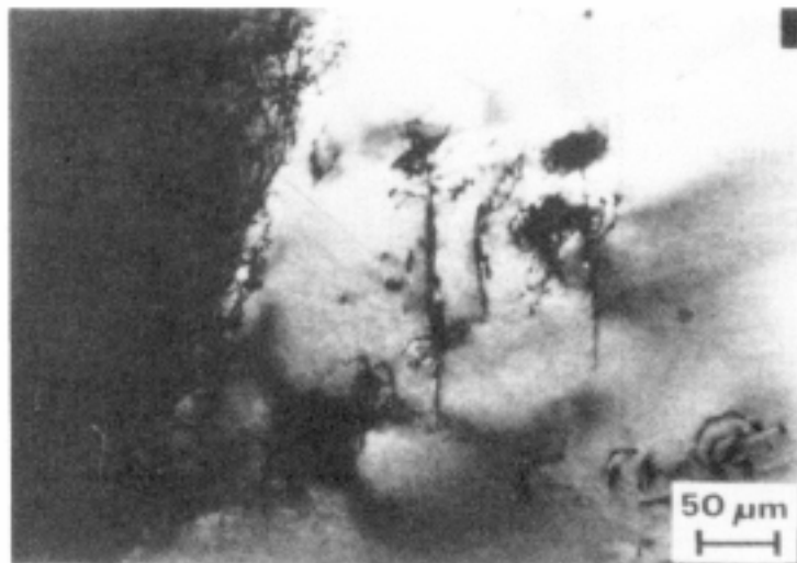
图 3 往 Ti-30Mo 合金中阴极充氢产生的位错团 [111]
